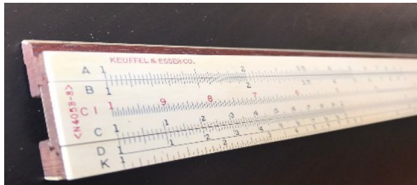
Figure 42 e 43. Regolo K&E 4053-3. Cursore in plastica e vetro con cornice metallica, closed frame, corpo e slide in legno. Finestrella posteriore in celluloido con indice per le scale S, L e T. ~1940.
