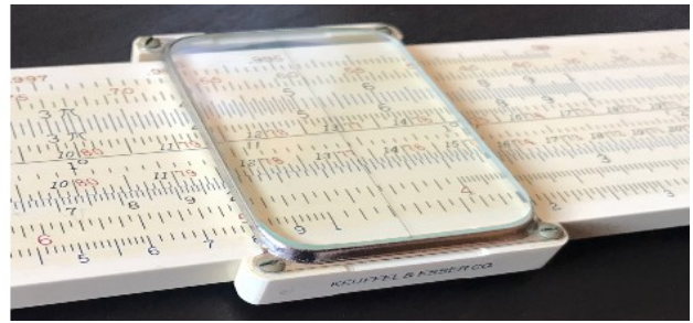
Figure 36 e 37. K&E, corpo e slide in mogano laminato celluloido, cursore in vetro e metallo, 1936.
