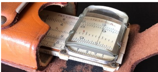
Figura 46. K&E N4053-3, cursore in plastica (danneggiata) e ottone con lente in vetro, 1936.
