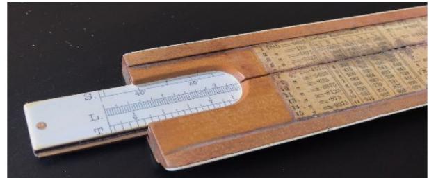
Figure 38 e 39. Regolo A.W. Faber 364. Closed frame, corpo e slide in legno. Finestrella posteriore aperta con indice sui bordi per le scale S, T e L. ~1913.
