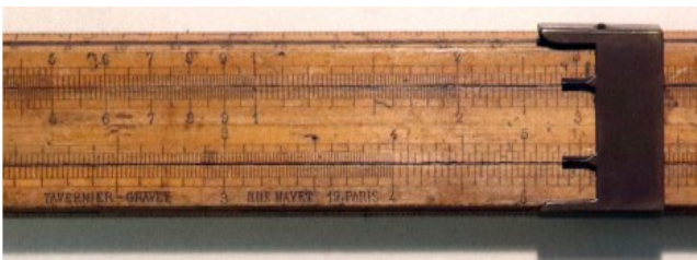
Fig. 32 e 33. Immagini di regoli Tavernier & Gravet di tipo Mannheim costruiti a fine 1800 (a sinistra) e inizio 1900 (a destra). Dal sito https://www.nzeldes.com/HOC/TavernierGravet.htm
