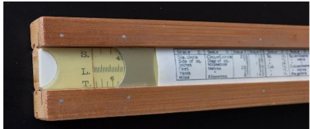
Figure 40 e 41. Regolo Sun Hemmi 130 Darmstadt. Cursore in alluminio e vetro, corpo e slide in bambù laminato in celluloido. Finestrella posteriore in celluloido con indice per le scale S, L e T. 1949.
