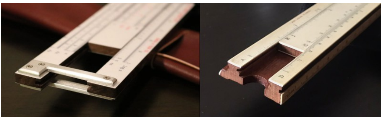
Figura 31. I tipi open-frame (a sinistra) e closed-frame (a destra).
