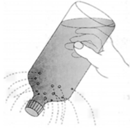
Fig. 10 Distribuzione uniforme della pressione in tutte le direzioni in un liquido.
