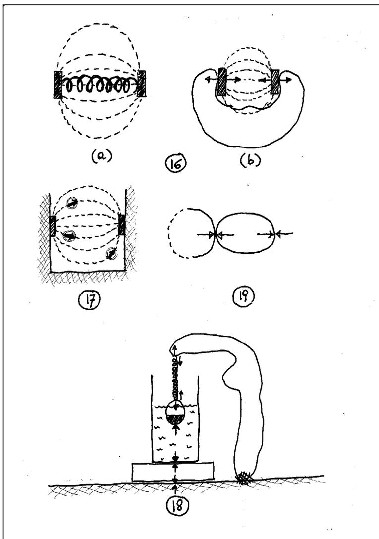
Figura 16a. Sistema-molla e sistema-campo interposti fra i due magneti: il campo fa-forza “per contrarsi”, la molla fa-forza “per espandersi”, la situazione è di equilibrio.
