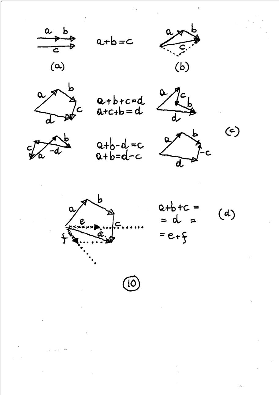
Figura 10. Operazioni di addizione e sottrazione fra vettori: a) due vettori paralleli; b) due vettori sul piano; c) somma, differenza, proprietà con più vettori; d) “decomposizione” della somma di tre vettori in una somma di due che hanno direzioni assegnate.
