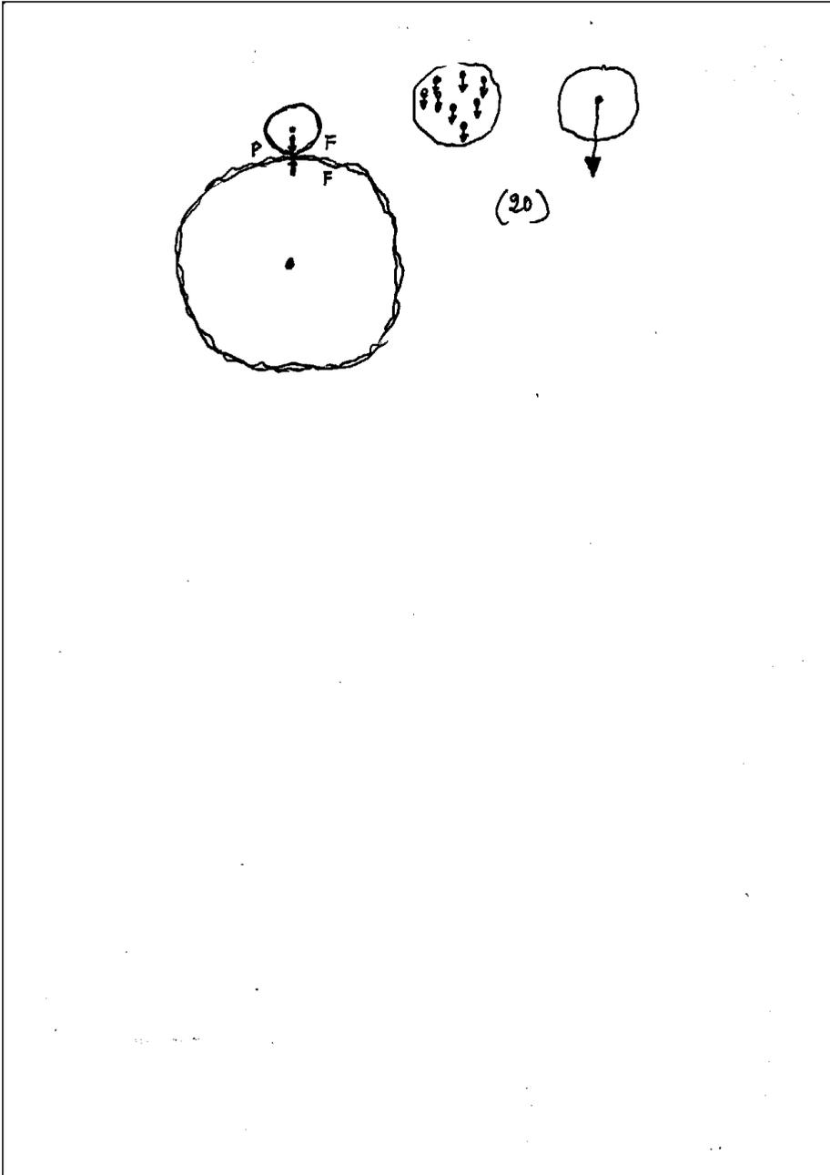
Figura 20. Un corpo in equilibrio sulla superficie della Terra: la somma  $F$  delle forze di attrazione sulle "parti piccole" agisce sulla superficie di contatto, dando luogo a una pressione  $P$ .
