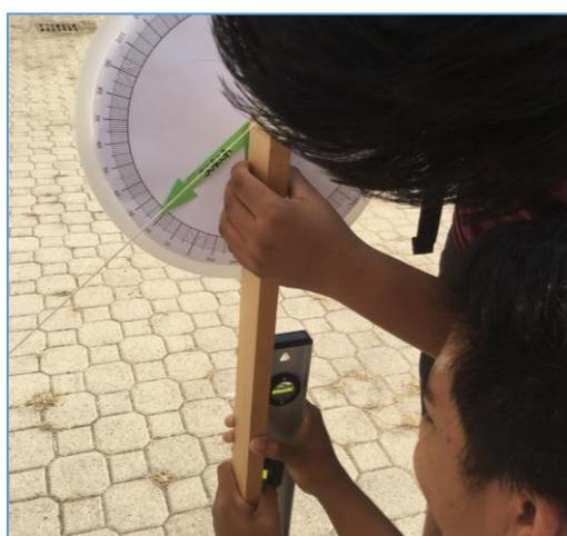
**Fig.7 - La misura diretta dell'angolo allo zenit, effettuata con un piccolo goniometro (7a) e con un misuratore d'angolo appositamente costruito (7b).**
