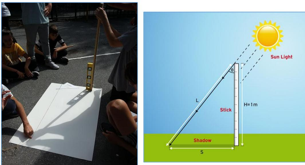
**Fig. 6 - Il setting per l'esperimento di Eratostene (6a): è stato disposto un foglio bianco rigido sul pavimento del cortile per raccogliere interamente l'ombra del Sole e renderla più visibile, si notano poi lo gnomone, il filo a piombo, la bolla o livella, la squadretta e lo spago tenuto teso tra l'estremità dello gnomone e quella dell'ombra. Modellizzazione dello stesso setting (6b).**
