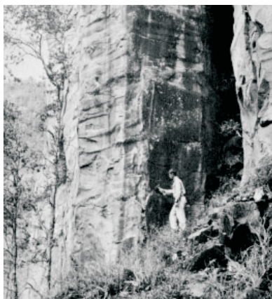
Misura dell'angolo sviluppato dalla fratturazione per raffreddamento in un materiale analogo alla lava (Hofmann et al., 2015)
